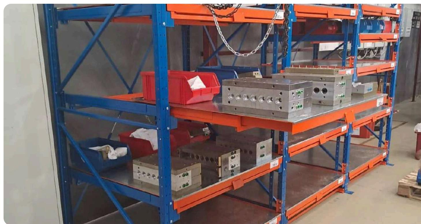
**Стеллажи для хранения оснастки (инструмент, небольшие штампы, формы для литья и т.п.): до 200 кг на полке полного выдвижения. Все стеллажи имеют защиту от одновременного выдвижения полок, фиксацию полок в рабочем (выдвинутом) и в состоянии полка «задвинута», крепление анкером к полам.**
