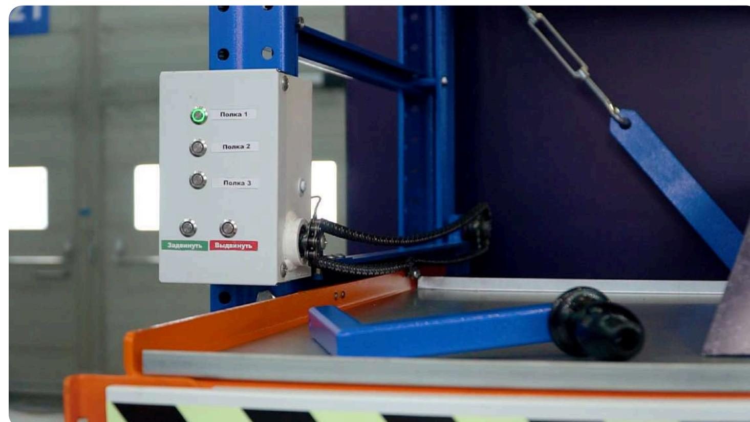
Стеллажи для хранения тяжелой оснастки (штампы, формы для литья и т.п.): до 1400 кг на выдвижной полке. Стеллажи имеют защиту от одновременного выдвижения полок, фиксацию полок в рабочем (выдвинутом) и в состоянии полка «задвинута», крепление анкером к полам.
