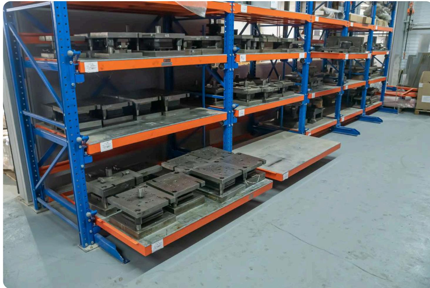
Стеллажи для хранения тяжелой оснастки (штампы, формы для литья и т.п.): до 1000 кг на выдвижной полке. Стеллажи имеют защиту от одновременного выдвижения полок, фиксацию полок в рабочем (выдвинутом) и в состоянии полка «задвинута», крепление анкером к полам.
