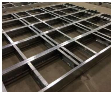
Мобильная база стеллажа
