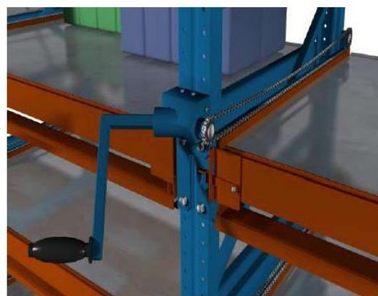
Привод от съемной рукоятки
