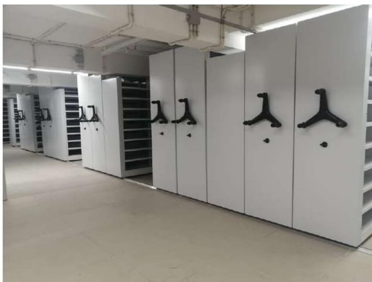
Стеллажи разных высот в одном блоке на одной рельсовой системе
