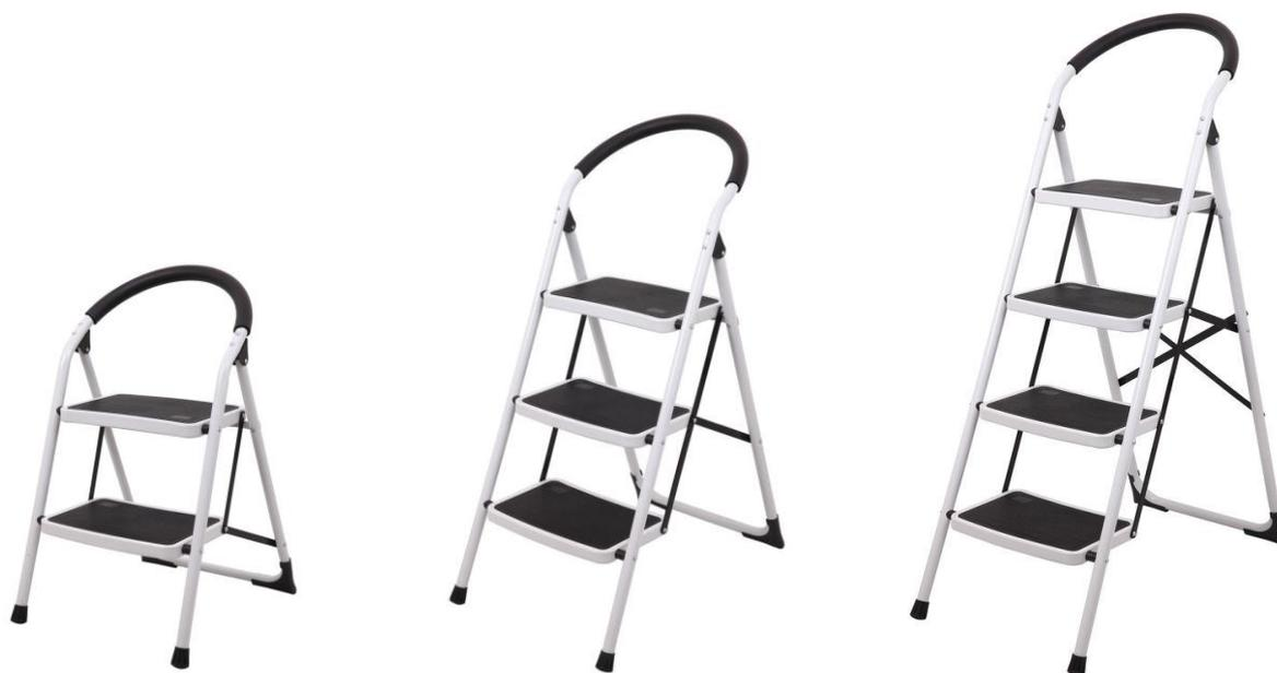
Материал каркаса: сталь. Покрытие ступеней – рифленый противоскользящий пластик. Имеют широкие ступени, обеспечивающие безопасность при работе. Размер ступеней в плане: 230 x 360 мм. Максимальная полезная нагрузка на стремянку 150 кг. Замок безопасности фиксирует конструкцию стремянки в рабочем (разложенном) состоянии. Изготовлены в соответствии с Европейским стандартом EN 131.
