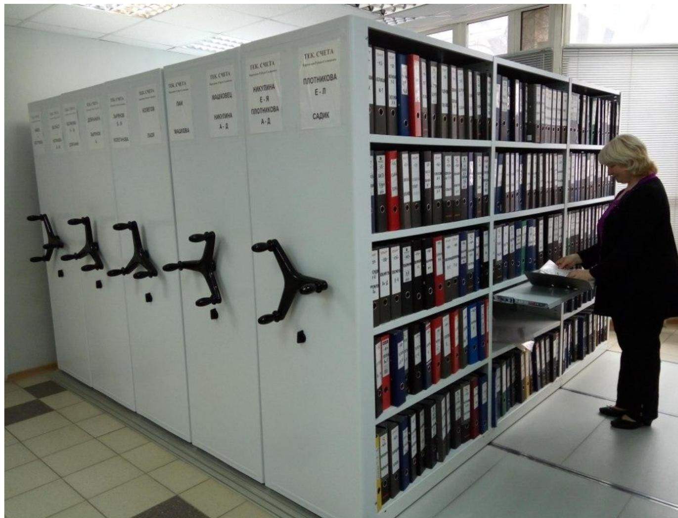
Фото 3 . Передвижные стеллажи с фальшполом. Серия «Л». Удобство и безопасность работы – фальшпол образует одну поверхность с рельсами. Возможность установки системы стеллажей на неровные полы. Просмотр хранимых документов на выдвигной полке.
