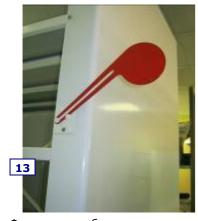
Флажок для обозначения нахождения работника в рабочем проходе между передвижными стеллажами
