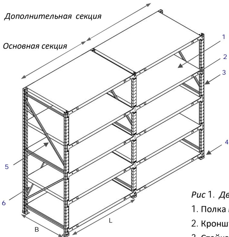
Рис 1. Двухсекционный стеллаж
